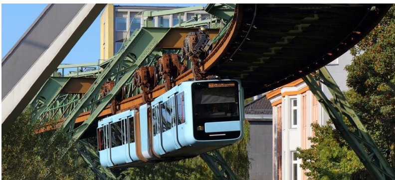
Rys. 3. Podwieszana kolej Schwebebahn
