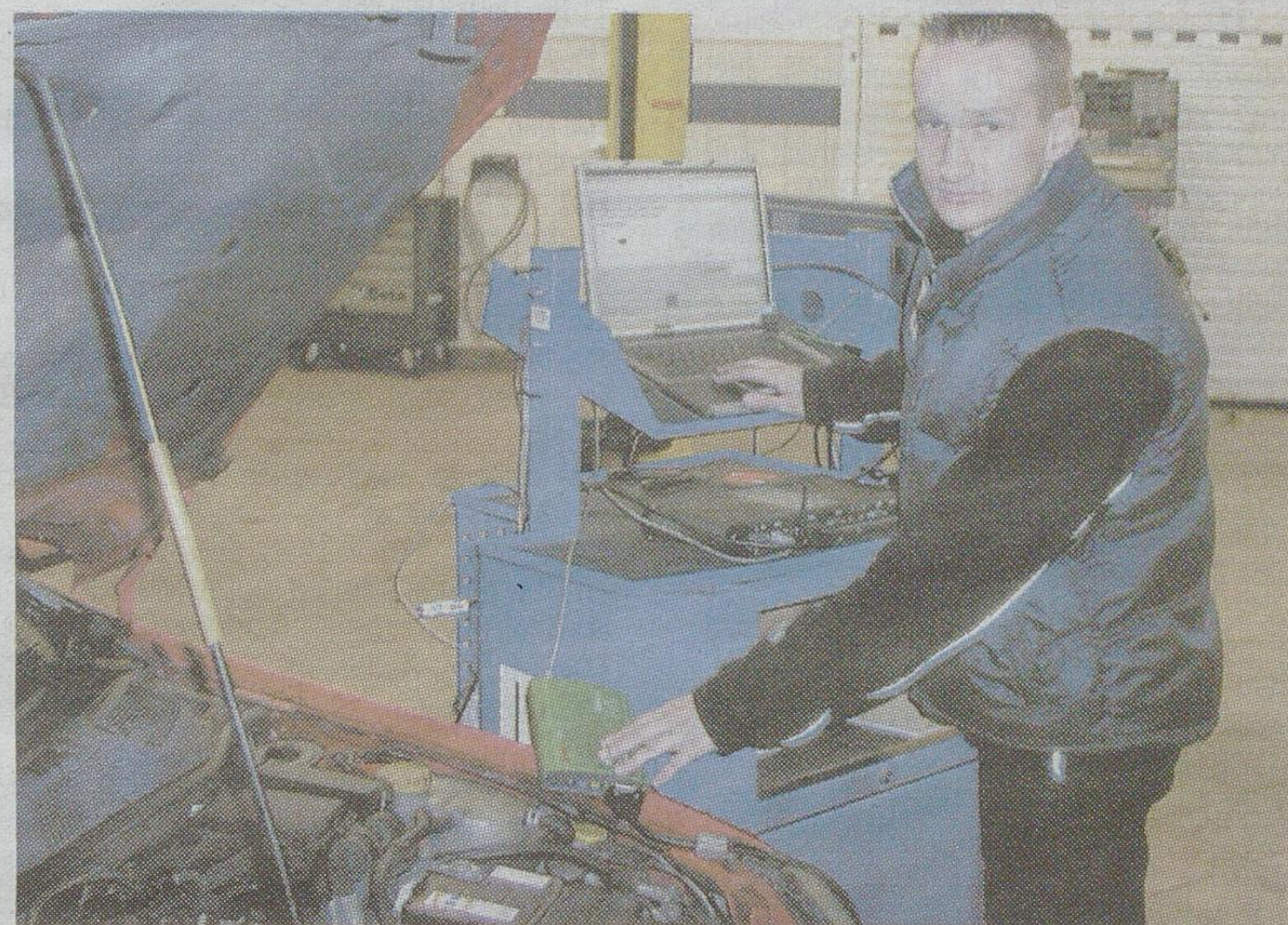
Kontrolę systemów elektronicznych przeprowadza się przy użyciu komputera
