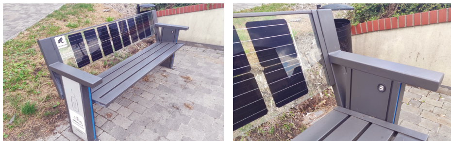
RYC. 4.19. Ławka w Bydgoszczy zasilana energią słoneczną, dzięki której można naładować telefon
