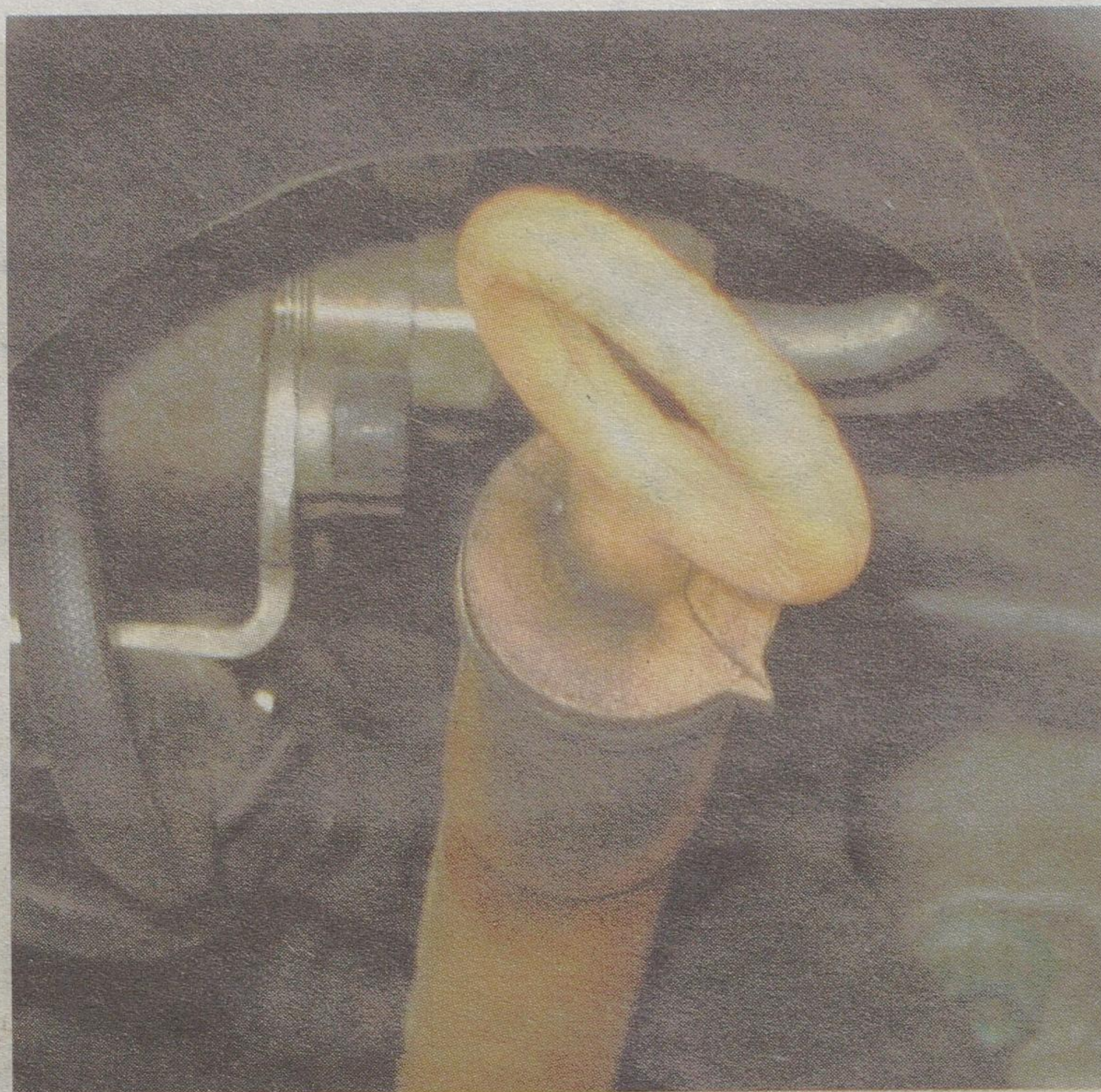
Przed każdą dłuższą trasą i raz na kilka tygodni, sprawdź poziom oleju za pomocą miernika bagnetowego
