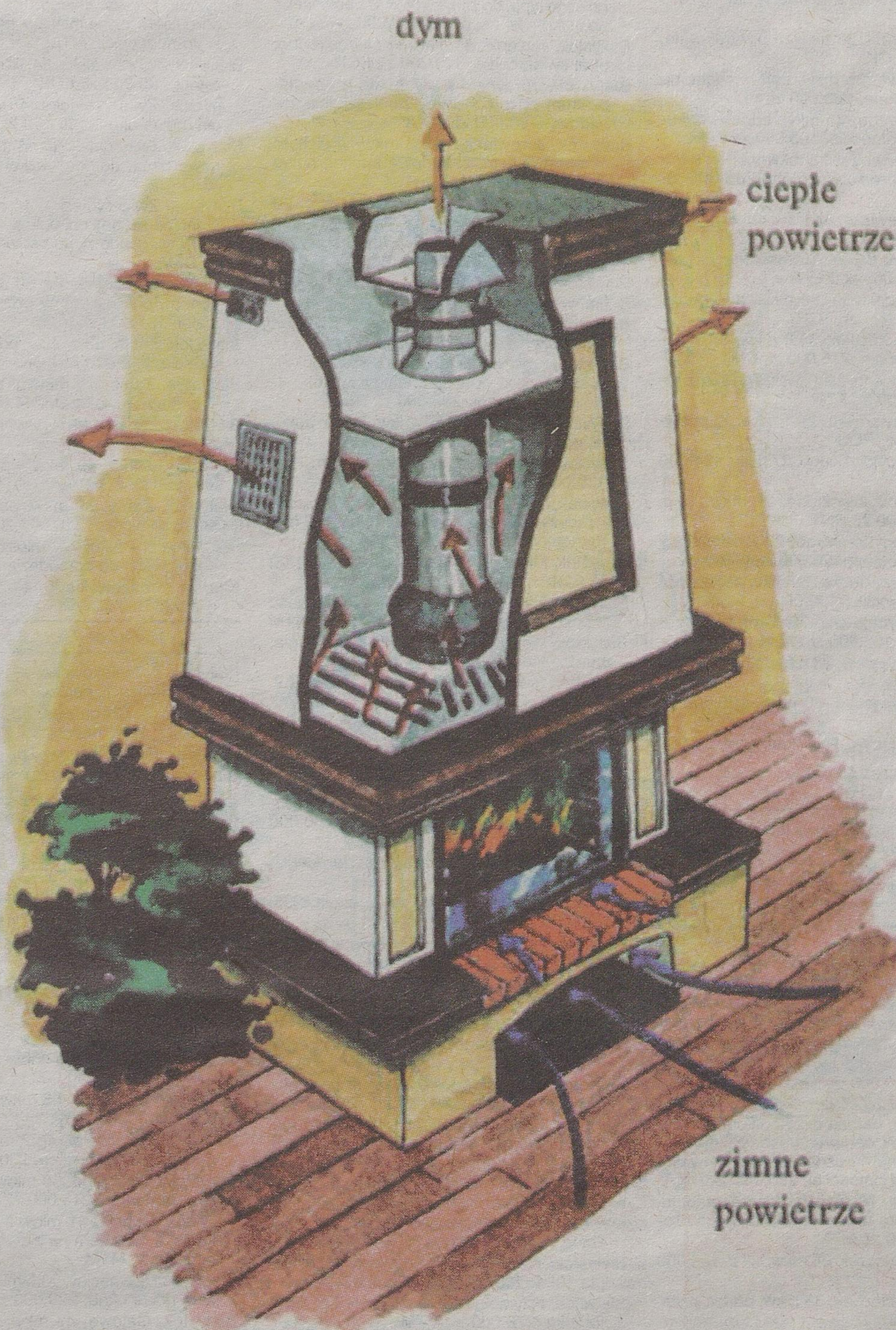
Powietrze opływające wkład ogrzewa się i unosi do góry kominka, a stamtąd – do kanałów dystrybucyjnych. Do ogrzania dalszych pomieszczeń stosuje się aparat zasysający gorące powietrze.
