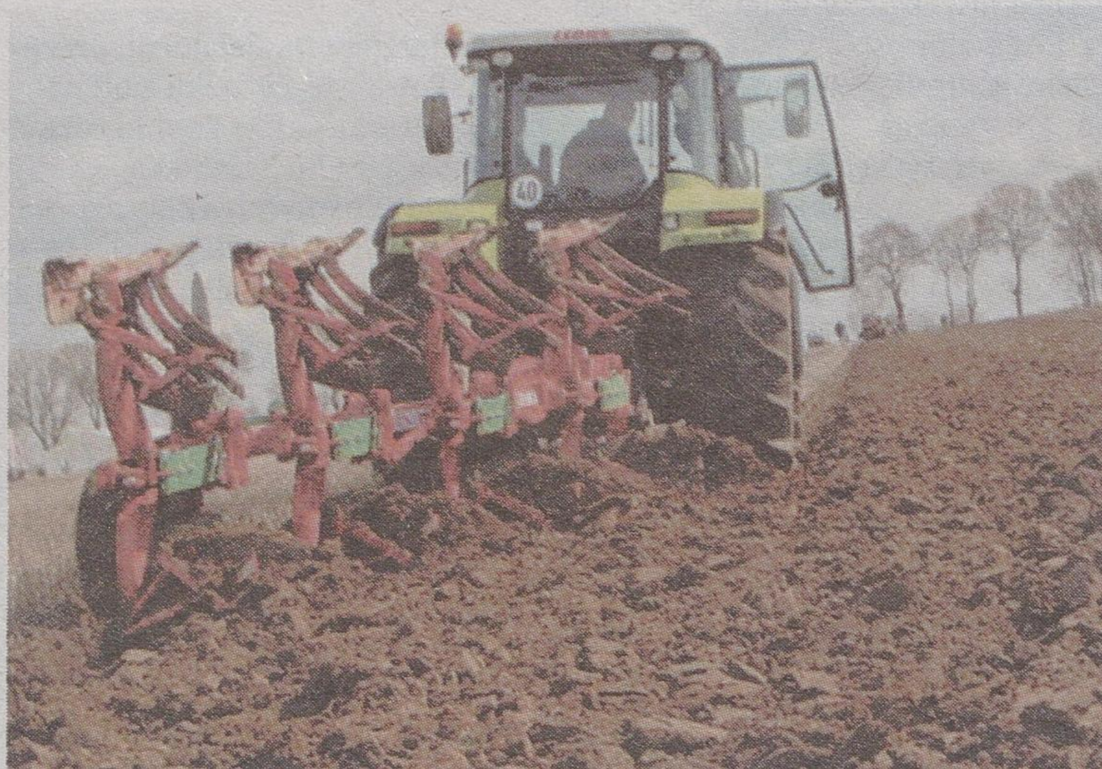
Pług z czterema korpusami - rozwiązanie, które sprawdzi się nawet w większym gospodarstwie
