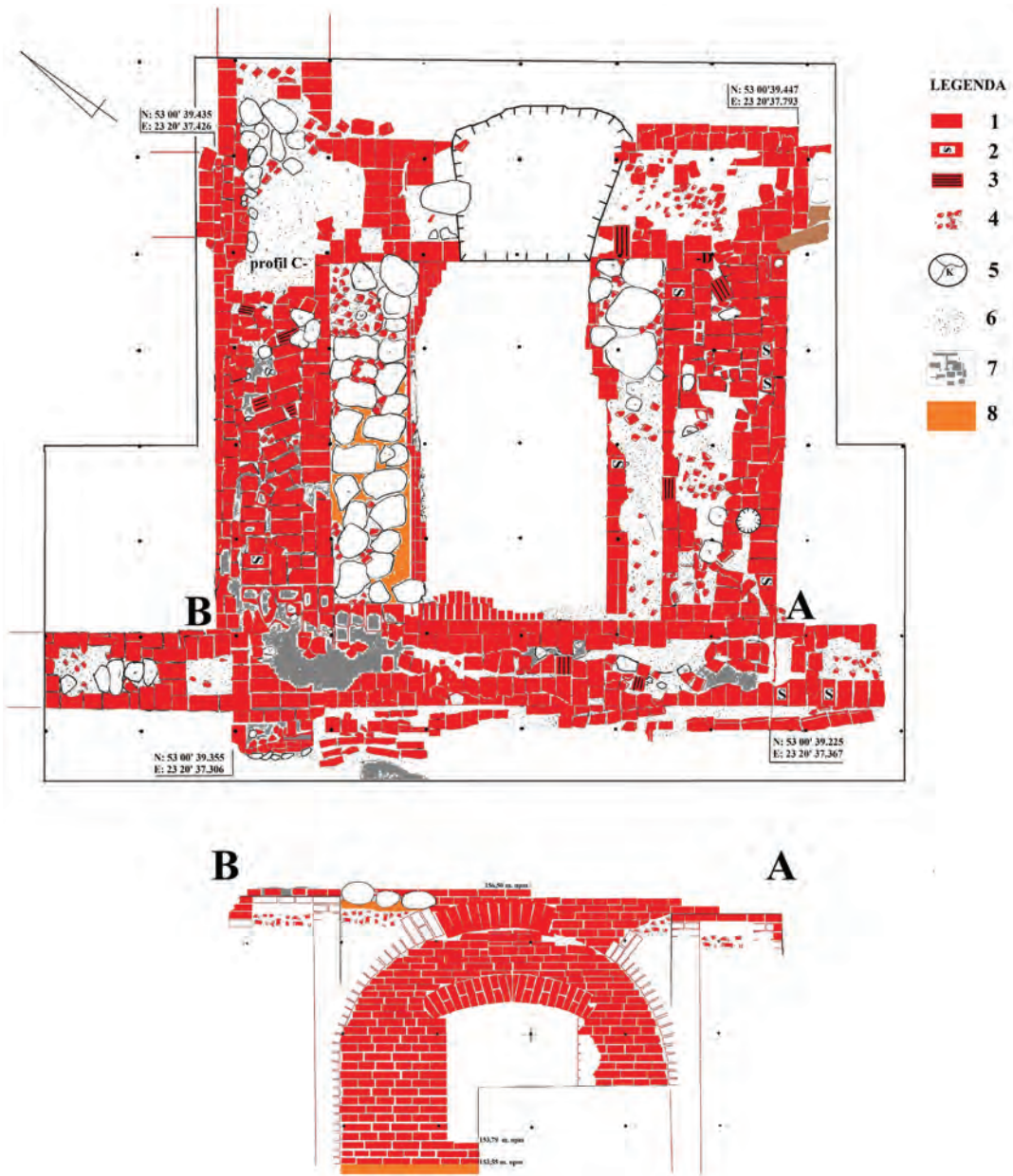
11. Zabłudów, pow. białostocki. Plan i profil (B-A) piwnicy budynku dworskiego. Legenda: 1 - cegła, 2 - cegła z symbolem „S”, 3 - cegła palcówka, 4 - gruz ceglany, 5 - kamień, 6 - zaprawa wapienna, 7 - zaprawa cementowa, 8 - piasek. Rys. L. Pawlata Zabłudów, Białostok County. The plan and profile (B-A) of the manor building basement. Legend: 1 - brick, 2 - brick with an “S” symbol, 3 - Gothic “finger” brick, 4 - brick rubble, 5 - stone, 6 - lime mortar, 7 - cement mortar, 8 - sand. Sketch by L. Pawlata
