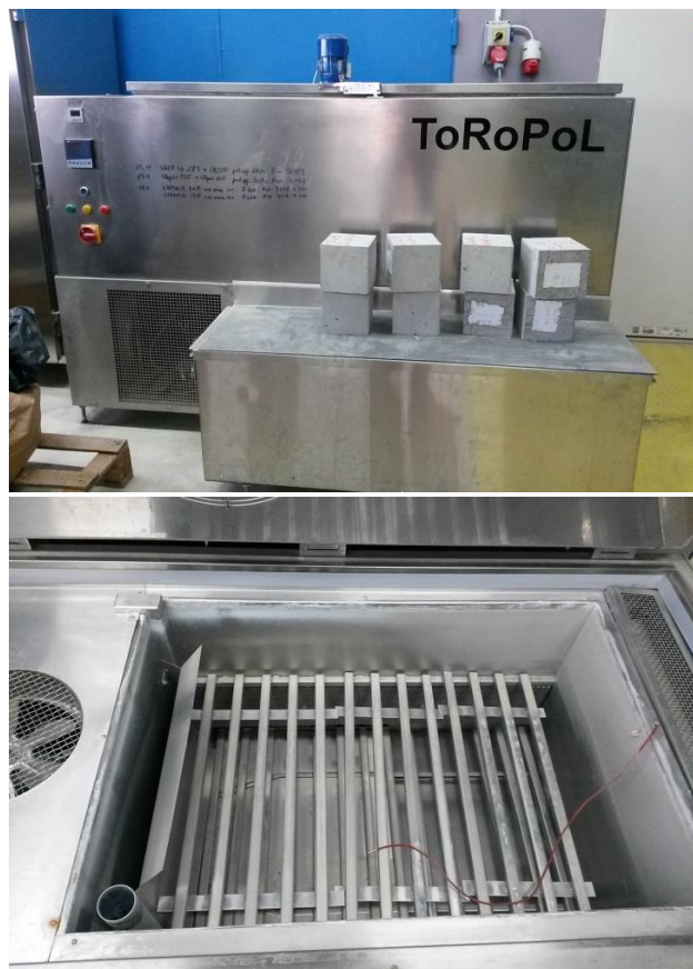
Rys. 2. Komora do badań mrozoodporności (fot. J. Karpiesiuk)
