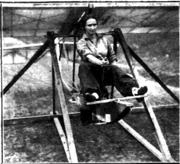
Młoda adeptka sztuki szybowania, p. Oganowska, podczas nauki szybowania na specjalnym aparacie, ustawionym na ziemi, lecz poddawany różnym naturalnym odchyleniom.
