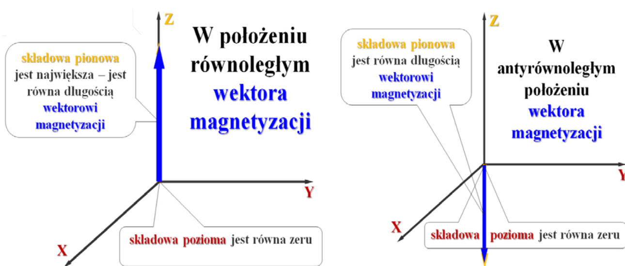
Rysunek II.2.4. Położenie równoległe i antyrównoległe wektora magnetyzacji.
