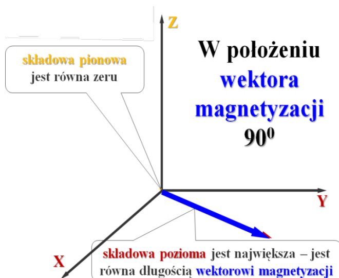
Rysunek II.2.5. Położenie prostopadłe wektora magnetyzacji.
