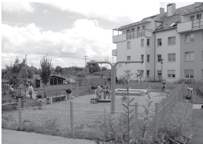
Ryc. 2.5. Prawidłowe rozwiązania placu zabaw: położenie w centrum zespołu zabudowy, w otoczeniu budynków mieszkalnych z możliwością nadzoru z okien ze wszystkich stron; plac zabaw ogrodzony, co zabezpiecza przed przypadkowymi zaczepkami oraz niespodziewanym oddaleniem się małego dziecka. Szczecin, osiedle przy ul. Gwarnej. Fot. autor
