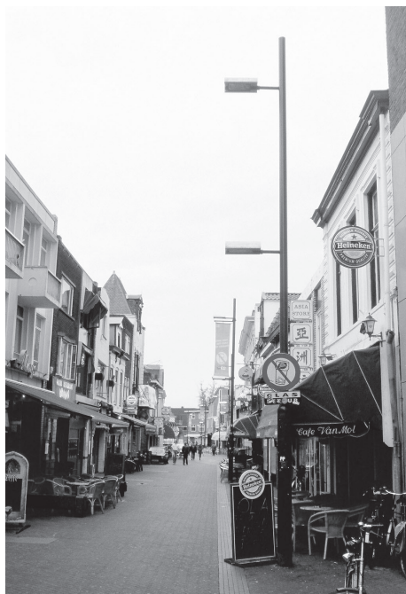
Ryc. 2.18. Strefa pubów w Eindhoven jako rodzaj „strefy kibi-ca” ze specjalnymi rozwiązaniami, między innymi oświetlenia: widoczne zdublowane lampy na jednym słupie oświetleniowym oraz znaki wyznaczające granicę strefy i informujące o obowiązujących regułach zachowania. Fot. autor
