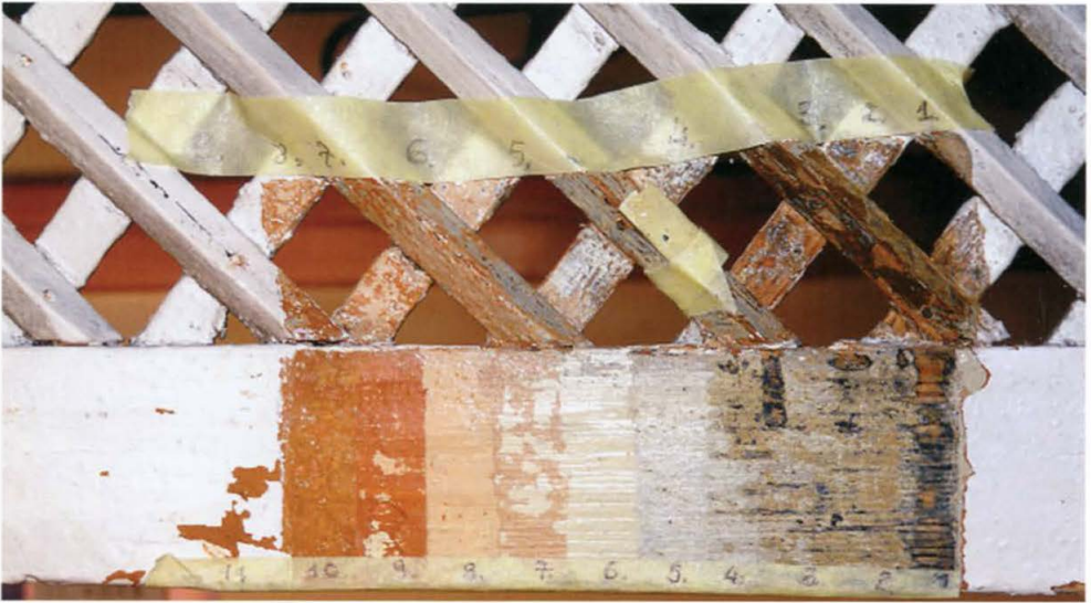
8. Fragment górnej partii boku szafy organowej. Widoczna stratygrafia warstw przemalowań. Fragment of the upper part of the organ case. Visible stratigraphy of layers of repainting.
