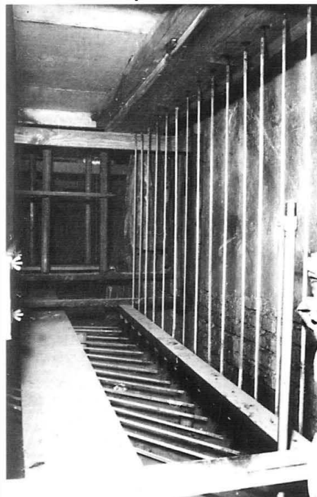
6. Elementy traktury klawiszowej zespołu dźwięku pedału. Fot. Marian Dorawa, 1999 r. Elements of the keyboard trackers of the pedal sound complex. Photo: M. Dorawa 1999
