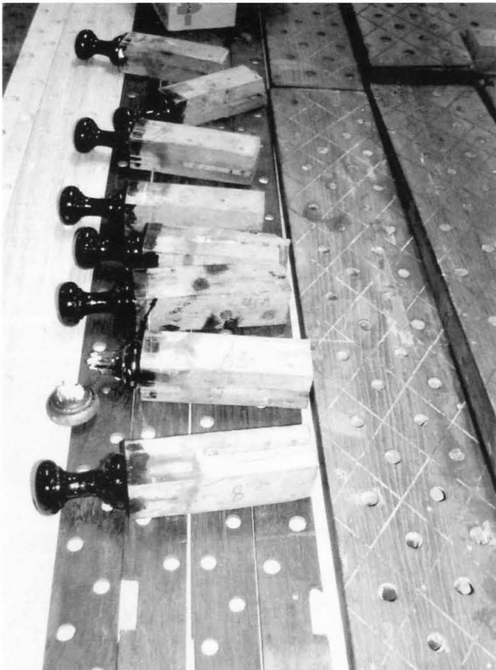
7. Zniszczone manubria rejestrowe oraz spody kłoców piszczałkowych. Damaged register manubria and bottoms of pipe locks.
