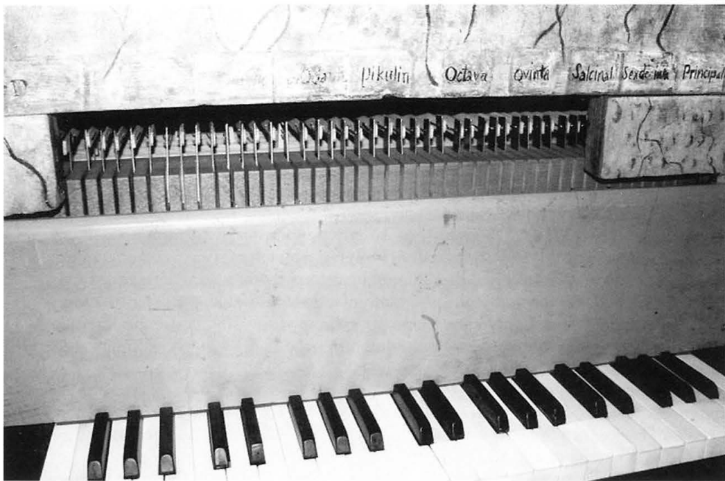
8. Fragment zespołu gry z odsłoniętymi spod warstwy przemalowań nazwami rejestrów pierwotnej dyspozycji. Fragment of instrument with the names of the original disposition registers uncovered under the layer of repainting.
