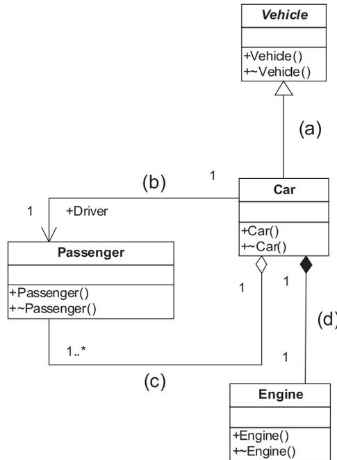
**Fig. 3. (a) Inheritance (b) Dependence (c) Aggregation (d) Composition Example**
