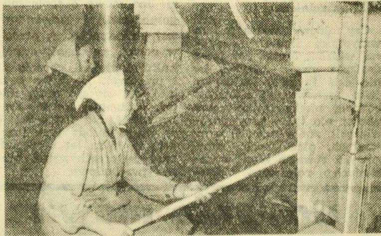
Te panie pracują przy obsłudze maszyny zwanej proktorem, czyli urządzenia służącego do wyrównywania wilgotności tytoniu idącego do fermentacji.
