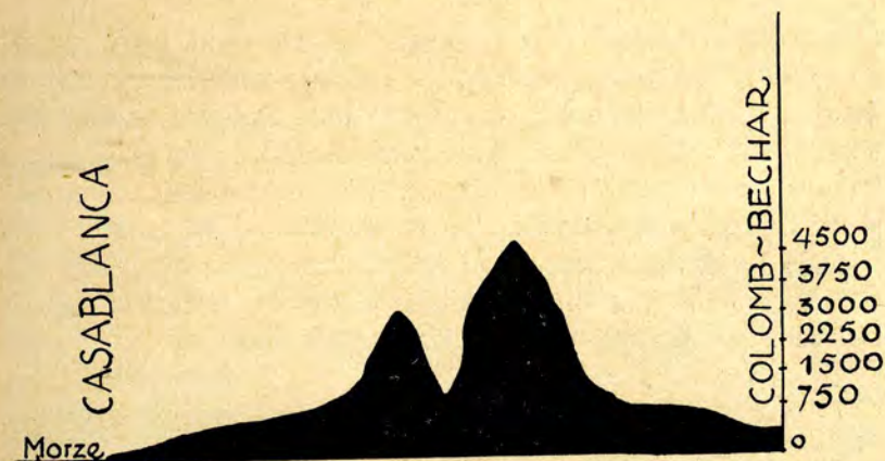
34. Szkicowy przekrój (profil), przeprowadzony od portu Casablanca w Marokku do oazy Colomb-Bechar w Algerze. Skala poziomowa 1:6.000.000, skala wysokościowa 1:150.000.
