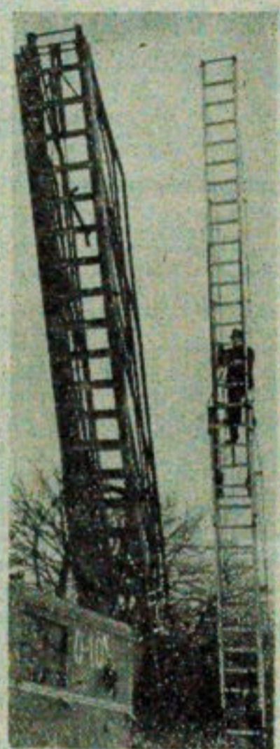
Turyści znają Paźków jako miejscowość słynną z zabytków, natomiast przedsiębiorstwa wiedzą, że to tu właśnie produkuje się drabiny strażackie różnych typów, syreny ręczne oraz law. działka wodne. NA ZDJĘCIU: na pierwszym planie 17-metrowa mechaniczna drabina, w głębi - 12-metrowa. CAF - fot. Uchymiak
