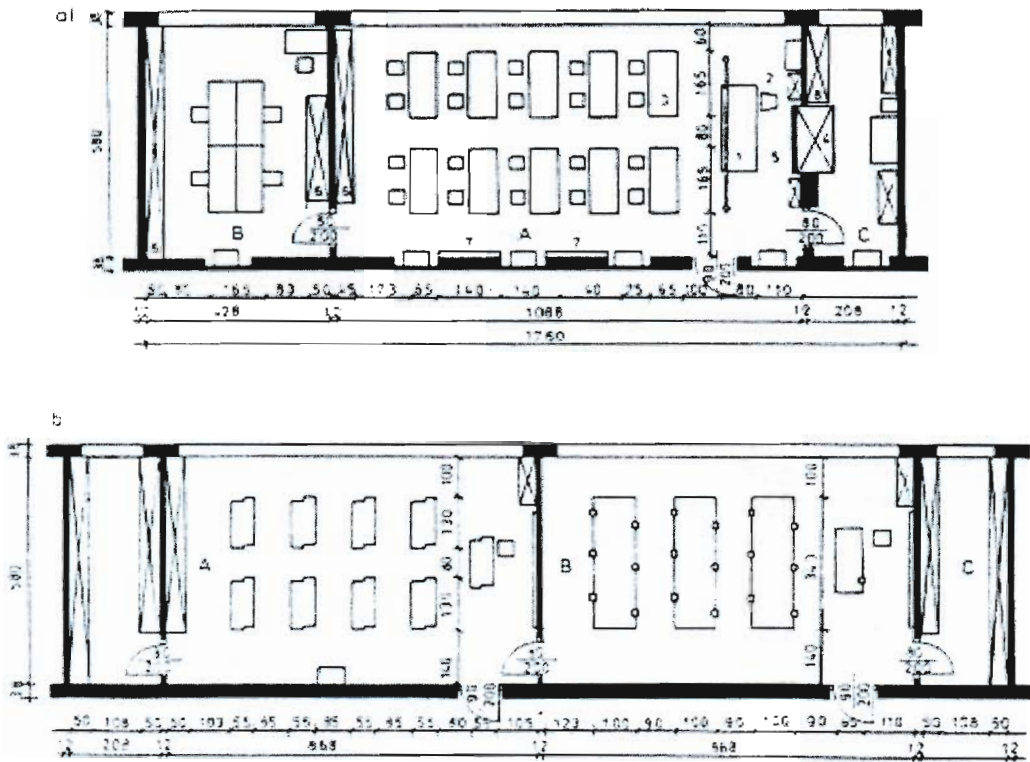
Il. 16. Sale specjalne 15 izbowej szkoły podstawowej (polskie opracowanie studialne, lata 60.) a) sala fizykochemiczna, b) sala zajęć praktyczno-technicznych
