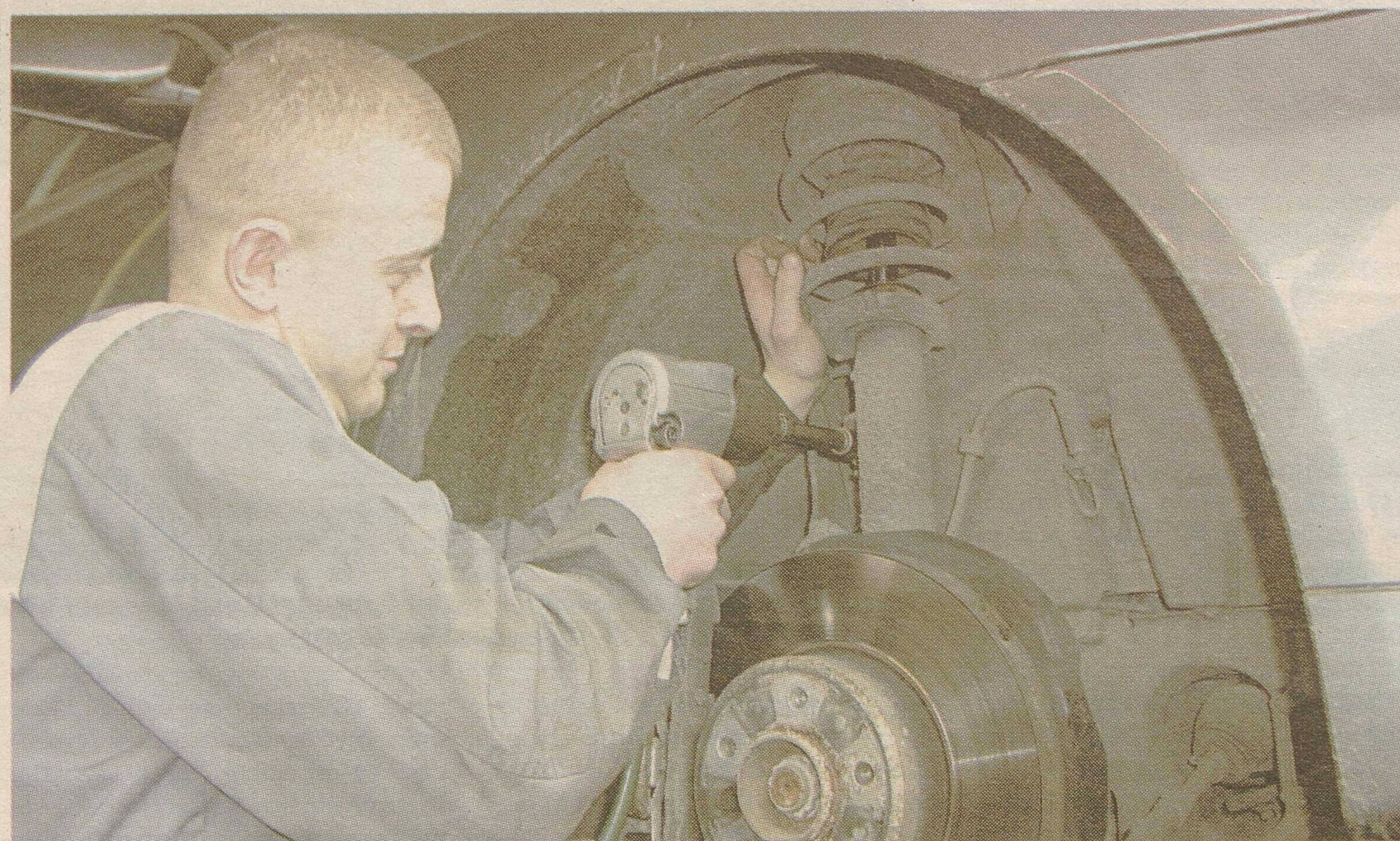
Jeżeli z amortyzatora wycieka olej, konieczna jest jego wymiana. Najlepiej robić to parami. W przeciwnym razie auto może być niestabilne podczas jazdy przy większych prędkościach.
