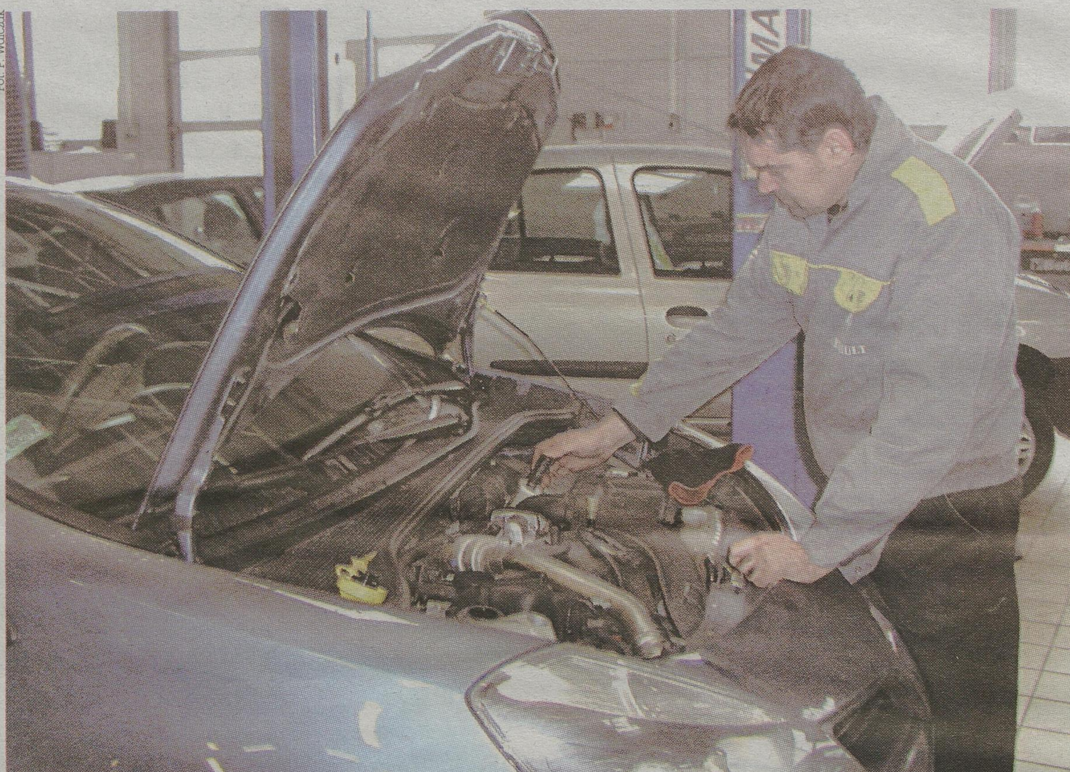
Po zimie sprawdzimy stan płynu hamulcowego. Jeżeli temperatura jego wrzenia będzie zbyt niska, podczas gwałtownego hamowania może się on zagotować.
