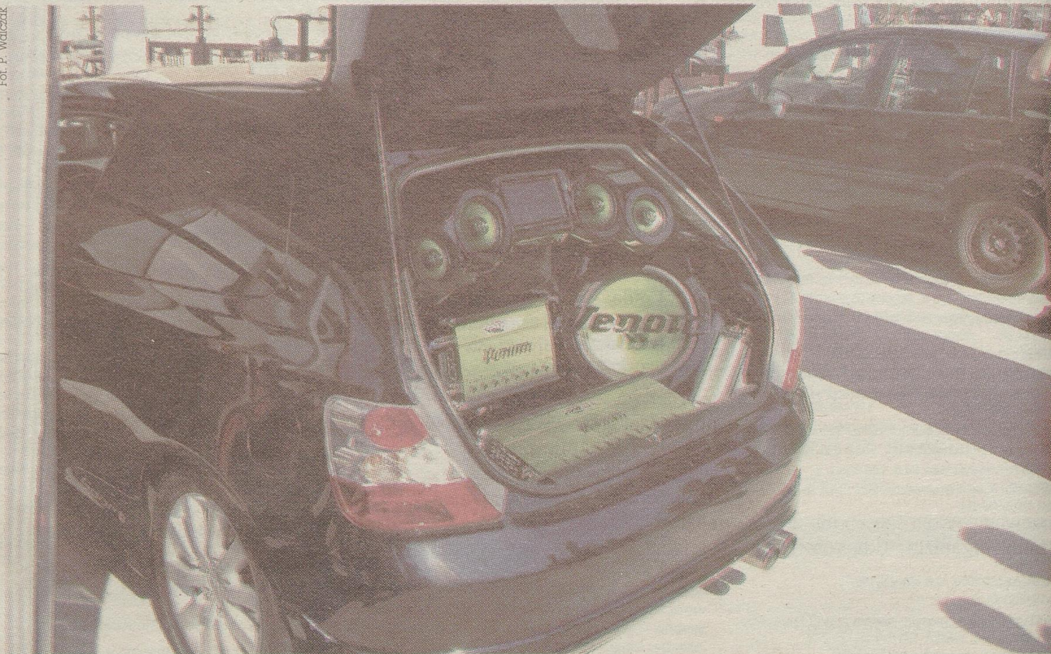
Bagażnik może być dużym polem do popisu dla kierowcy-audiofila. To najlepsze miejsce na wzmacniacz, system zasilania i głośniki niskotonowe
