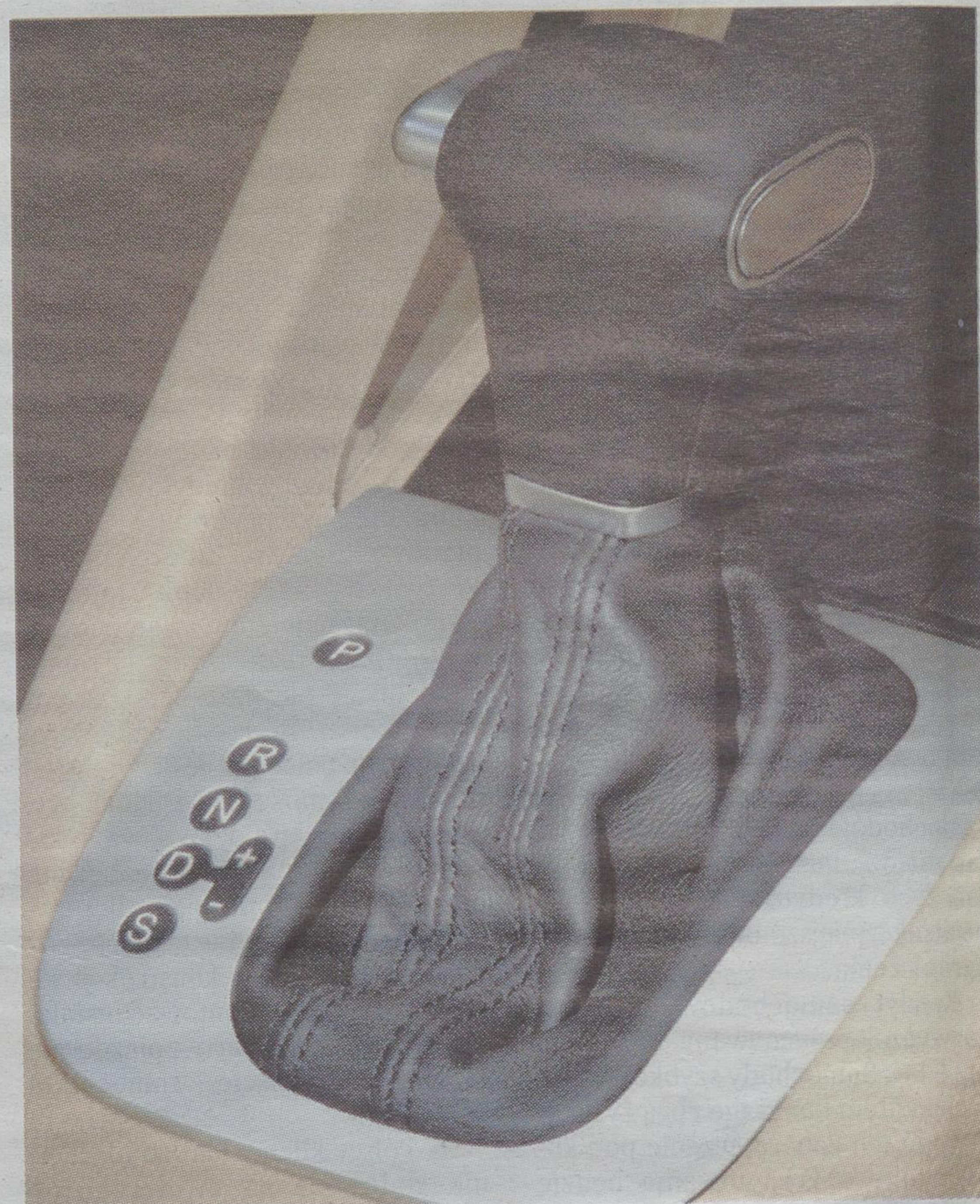
Skrzynia biegów DSG, czyli komfort skrzyni automatycznej i kontrola jak w przekładni ręcznej
