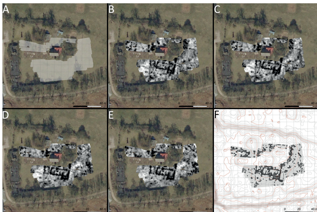
2. Tykocin, stan. 38, kępa bernardyńska, gm. Tykocin, woj. podlaskie. Geofizyka. Wizualizacja i analityczne kartowanie danych georadarowych przetworzonych do postaci cięć czasowych. A – obszar badań; B–E – cięcia czasowe na kolejnych głębokościach względnych; F – interpretacja anomalii georadarowych pod kątem pozostałości archeologicznych. Oprac. P. Wroniecki Tykocin, site 38, Bernardine Hillock, Tykocin Commune, Podlaskie Voivodeship. Geophysics. Visualisation and analytical mapping of GPR (Ground Penetrating Radar) data processed into time-slice cuts. A – research area; B–E – time slices at successive relative depths; F –interpretation of GPR anomalies in the context of archaeological remains. Prepared by P. Wroniecki
