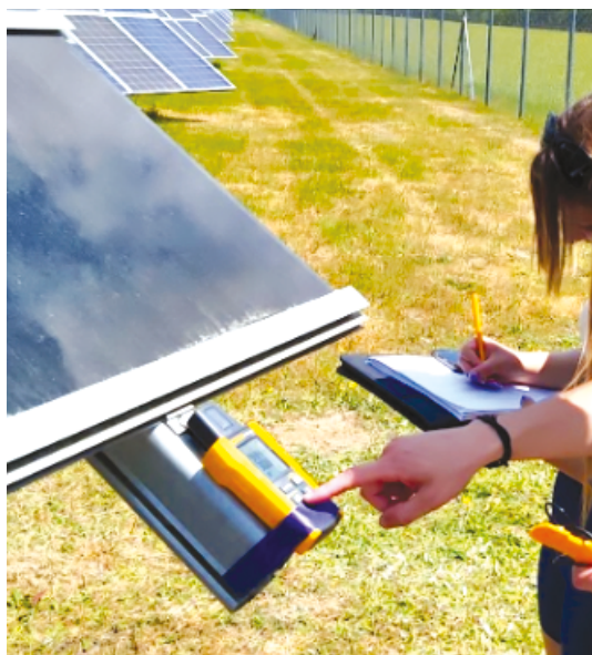
RYS. 4. Miernik temperatury przymocowany do szyny fotowoltaicznej
