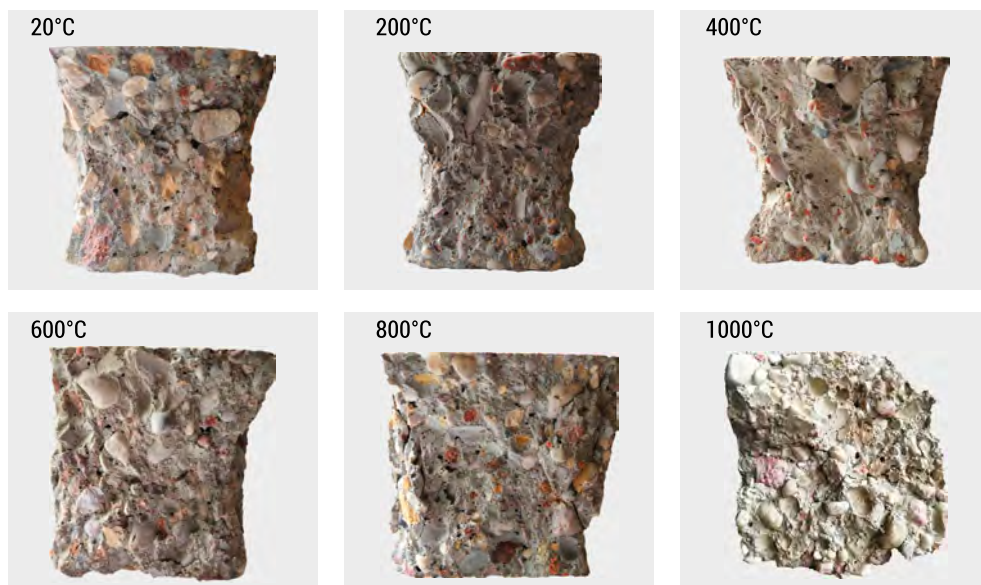
RYS. 3.4. Przelamy próbek (serie 1–6) wygrzewanych w temperaturach według planu badań ŹRÓDŁO: fot. autorka.
