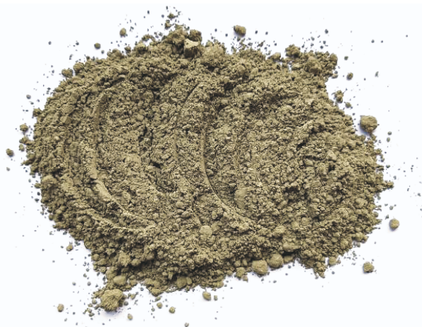
RYS. 3.13. Zbrylony zaczyn cementowy po wyprężeniu w temperaturze 1000°C
