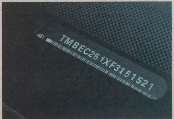
Tabliczka z numerem VIN na podszybiu po stronie kierowcy
