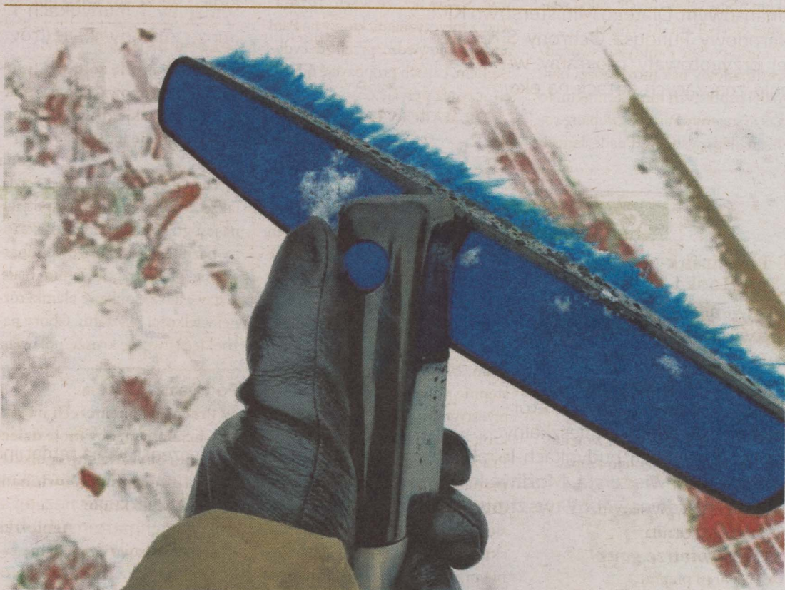
Wielu kierowców może nie wiedzieć, że w teleskopowej zmiotce do odgarniania śniegu z samochodu jest przycisk, pozwalający zmienić ustawienie szczotki o 90 stopni. Wystarczy wcisnąć przycisk, który często przybiera formę „kulki”, traktowanej jako bezużyteczną ozdobę. Zmiana kąta szczotki świetnie pomaga w odśnieżaniu dachu! Fot. pixels
