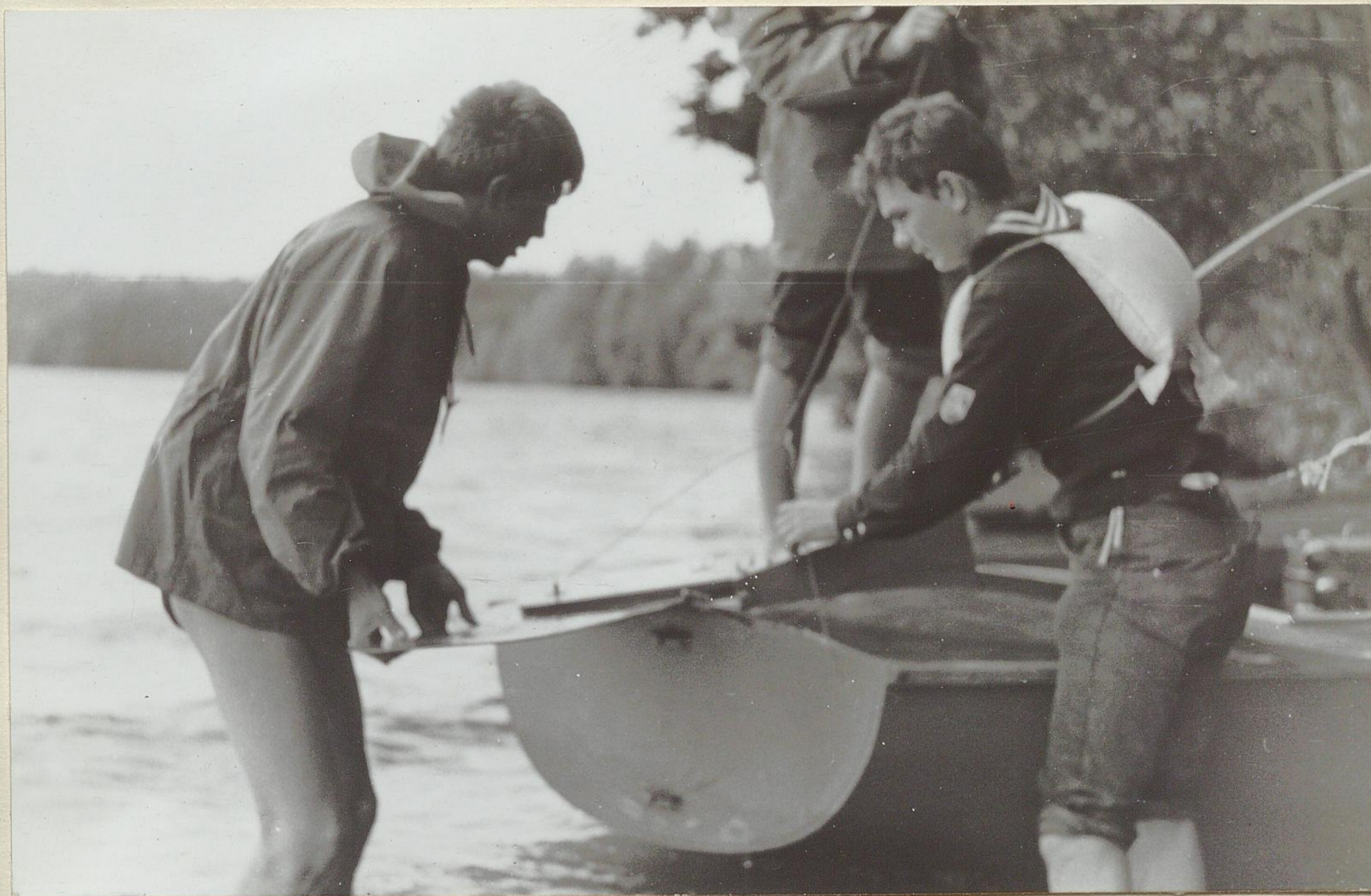
Awaria na Koli. Reperacja wyrwanego przetyku steru.
