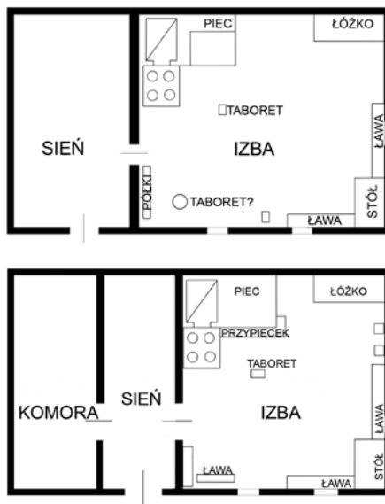
Rys. 3.7. Rzuty wolno stojących domów wschodniopodlaskich z przyściennym usytuowaniem pieca; na podstawie: [214, s.162–163]
