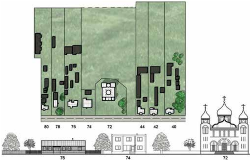
Rys. 2.12. Przykłady usytuowania zagród i pierzeje ulicy we wsi gminnej Czyże; na podstawie inwentaryzacji wykonanej przez WAPB podczas praktyki wakacyjnej w lipcu 2010 roku
