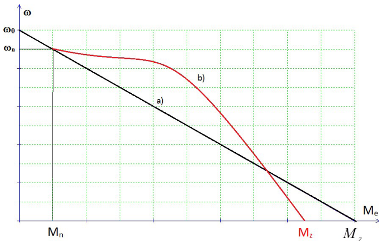
Rys. 1.31. Charakterystyka mechaniczna silnika obcowzbudnego: a) obwód magnetyczny liniowy, b) uwzględnienie poprzecznej reakcji twornika
