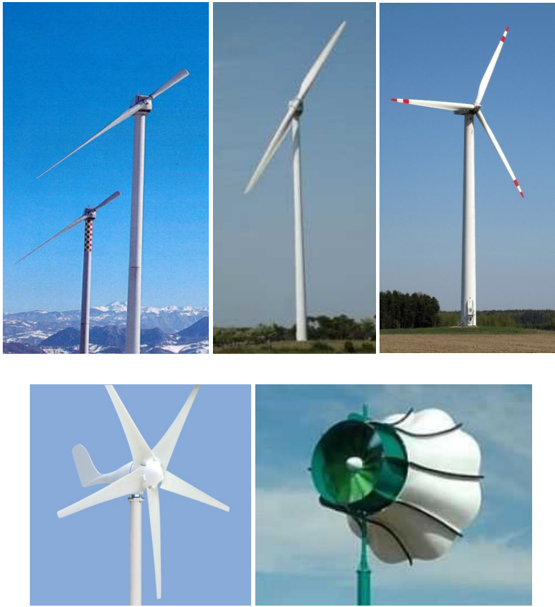
Rysunek 4.1. Przykład turbin wiatrowych o poziomej osi obrotu: jedнопłatowej, dwupłatowej, trzypłatowej, wielopłatowej oraz turbiny z dyfuzorem [3]
