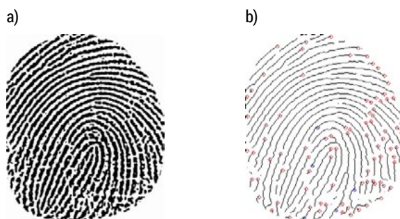
RYS. 4. Oryginalny obraz pobrany z użyciem skanera odcisków palców (a) oraz obraz po przetworzeniu i ekstrakcji cech (b)
