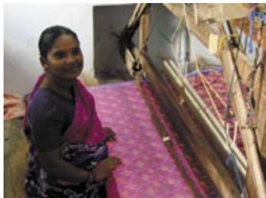
Indie, wieś Pochampaly, tkanie w technice Ikat na ręcznym krośnie
