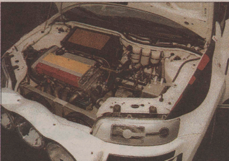
Silnik o pojemności 1,6 l i mocy 215 KM. Maszyna, która potrafi bardzo szybko poruszać to auto.
