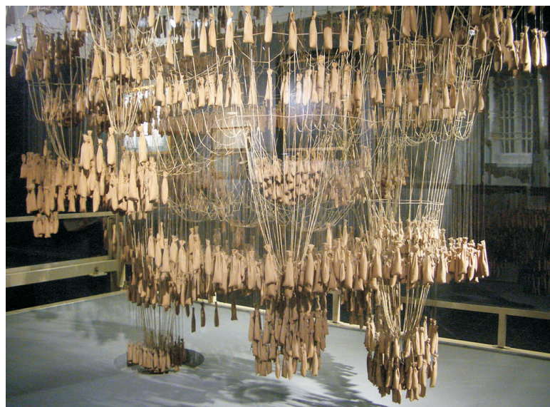
Ryc. 7. Fizyczny model przestrzenny Gaudiego, w którym liny dostosowują się kształtem do obciążenia umieszczonego w workach; źródło: © tillnm – https://www.flickr.com/photos/tillnm/3209875667/in/photostream/ dostęp: 14.02.2019
