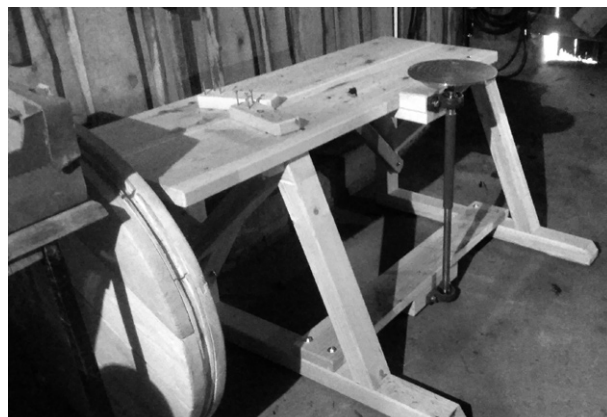
Ryc. 18. Stół z kołem garncarskim w pracowni Pawła Piechowskiego; fot. J. Ciecuch i P. Gołębiowski, 2016
