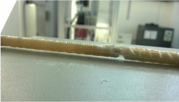
Rys. 4. Pręt GFRP po próbie rozciągania osiowego
