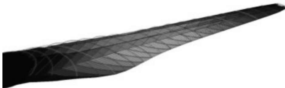
Rys. 1. Model strukturalny powłoki łopaty
