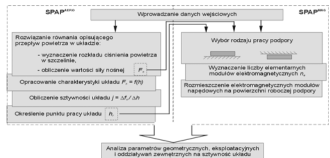
Rys. 5. Etapy badań płaskiej aerostaticznej podpory współrzędnościowej z napędem elektromagnetycznym
