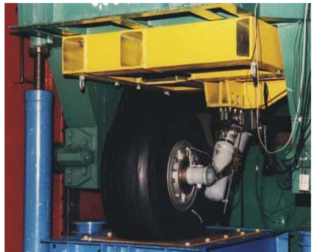
Rys. 2. Widok stanowiska opadowego do testów laboratoryjnych z badanym podwoziem głównym
