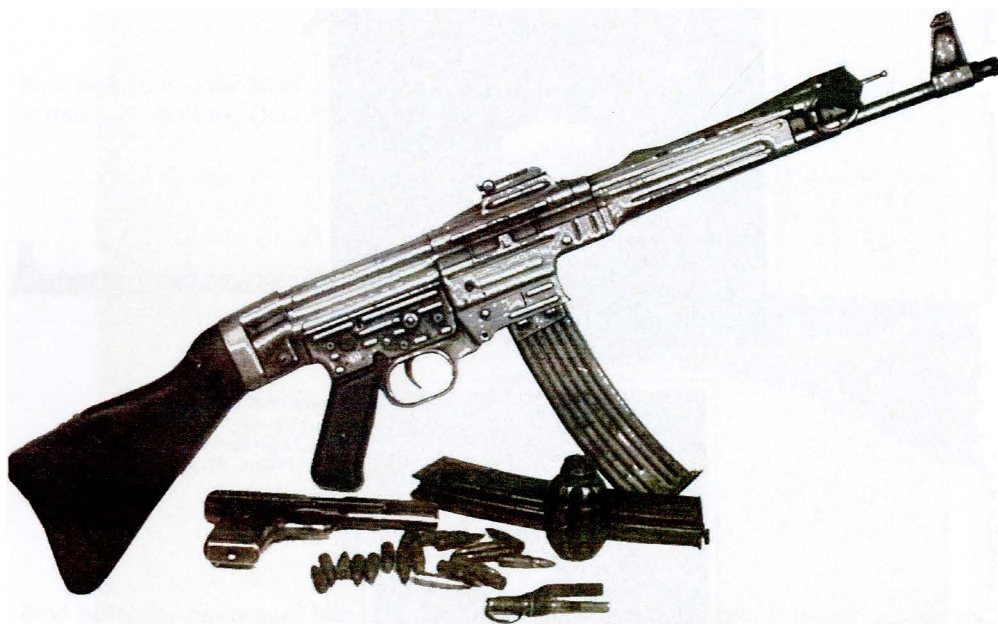
Broń będąca w posiadaniu żołnierzy podziemia niepodległościowego. Niemiecki karabin szturmowy Sturmgewehr (StG. 44) kaliber 7,92, pistolet leżący to sowiecka TT-ka (Tuła – Tokariew), kaliber 7,62, granat to sowiecki granat ręczny F – 1. Zdjęcie broni w zbiorach Archiwum Państwowego w Białymstoku.
