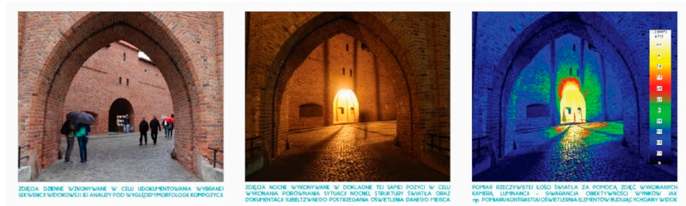
Il. 2. Od lewej: Zdjęcie dzienne danego kadru składowego sekwencji widokowej; zdjęcie nocne wykonane z identycznej pozycji; wynik pomiaru natężenia oświetlenia kamerą luminancji w pseudo-kolorze [ \text{cd}/\text{m}^2 ] (autor: M. Pożarowski)
