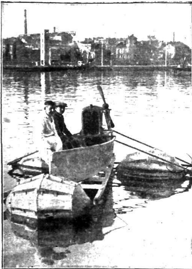
Ślizgowiec poruszany zapomocą śmigła, posiadający silnik o 9 koniach mocy mogący rozwinać szybkość do 120 km. na godzinę, którego pokaz został niedawno dokonany przez wynalazcę Eckerleina na Sekwanie w Paryżu.
