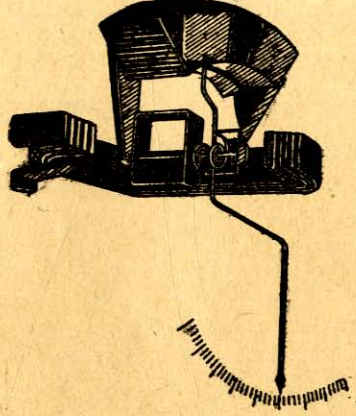
Rys. 144. Watomierz z jedną cewką nieruchomą a drugą ruchomą (elektrodynamiczny).
