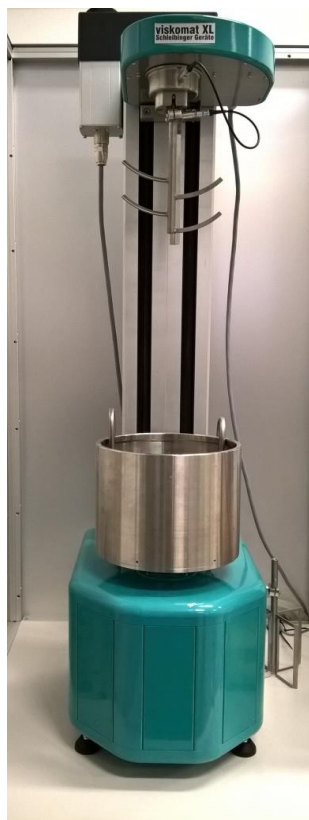
Rys. 3. Maszyna pomiarowa Viskomat NT - XL oraz mieszadło
