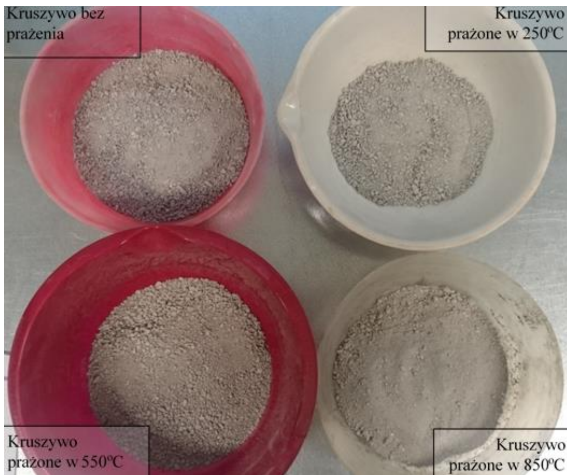
Rys. 1. Kruszywa z recyklingu stosowane do zapraw cementowych w zależności od temperatury prażenia
