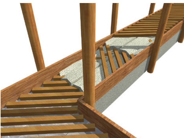
Ryc. 5. Ukośny wążek ściany drzewowapiennej; źródło: rys. autorki
