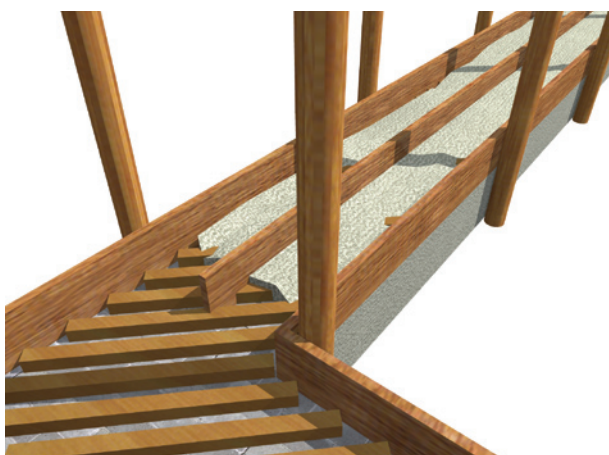
Ryc. 7. Sposób uzyskania pustki izolacyjnej w warstwie zaprawy w ścianie drzewowapiennej; źródło: rys. autorki
