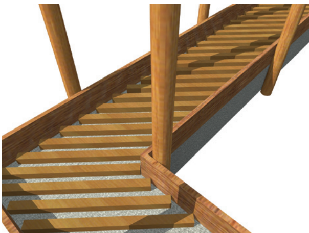
Ryc. 4. Wznoszenie ścian drzewowapiennych w szalunku na ruszcie słupowym; źródło: rys. autorki
