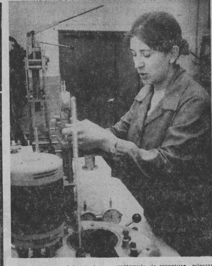
W zakładowym laboratorium przygotowuje się recepturę mieszanki woskowej do produkcji termostatów. NA ZDJĘCIU: ELŻBIETA BRZOZKO przy ultratermostacie, w którym bada parametry czujnika termostatu. Fot. Gabor Lorinczy
