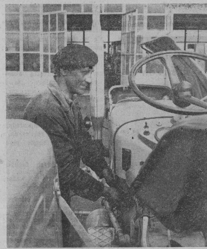
Czesław Nowicki — przodujący pracownik POM — podczas regulacji luzu układu kierowniczego w „Ursusie” C-360. Fot. Gabor Lorinczy
