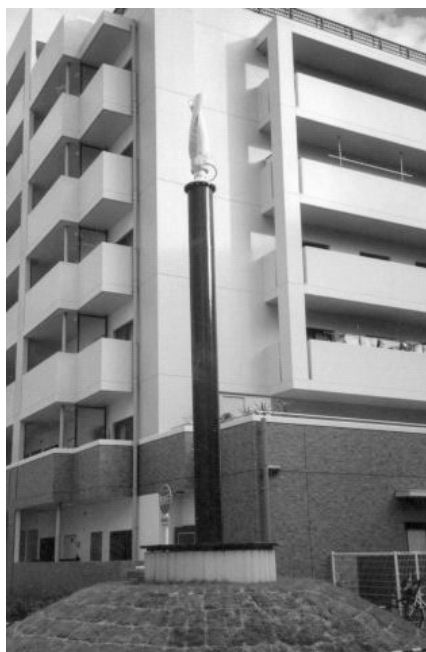
Rys. 7. Nowoczesna odmiana konstrukcyjna turbiny Savonius'a (świderkowa) wykonana przez firmę Windside w zabudowie miejskiej – Japonia ( www.windside.com )
