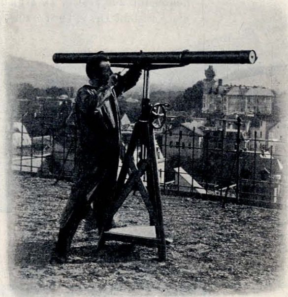
Fig. 55. Justieren eines binokularen Standfernrohres für Aussichtszwecke. (Die Okulare sind in der Mitte des Rohres, wenn auch schwach, sichtbar, die Objektive liegen an den Enden, aber nach hinten, sind also nicht zu sehen.)
