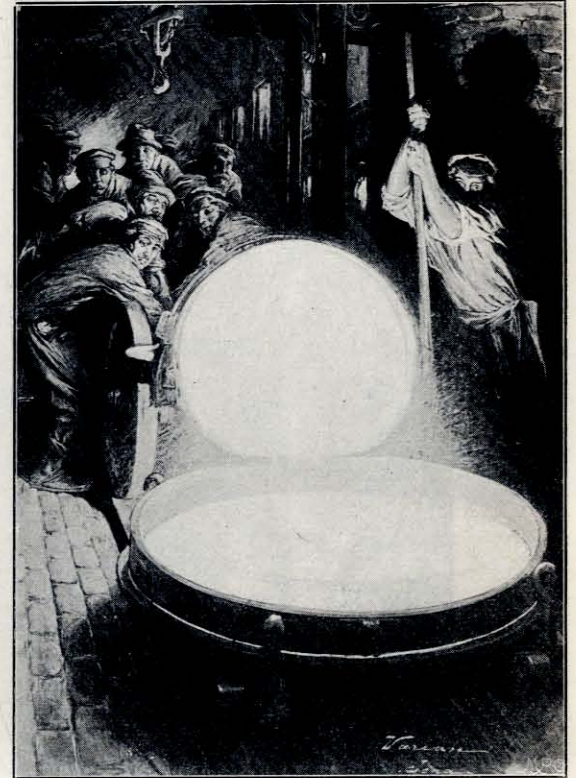
Fig. 74. Guß einer großen Linse in der Glashütte. (Nach einer Tuschzeichnung.)
