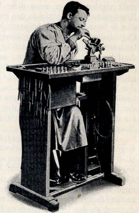
Fig. 79. Fassen kleinster Linsen.
